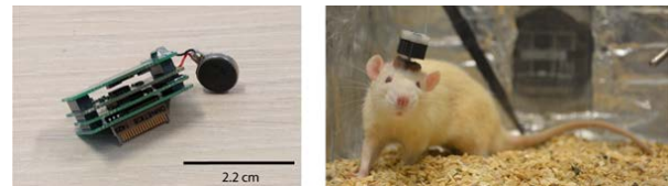
Figure 2 : Illustration du dispositif Oneiros avec moteur vibrant et photo d'un rat avec le système encapsulé dans un boîtier.
